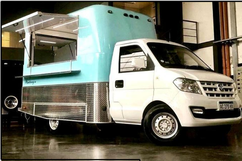
Dimensiones útiles: 3.10m largo x 1.70m ancho x 1,92m alto. Carrocería en fibra de vidrio. Aberturas: ventana lateral y puerta trasera. Piso forrado en goma. Paredes internas en fibra de vidrio. La versión FULL incluye: forrado interior en fibra de vidrio, instalación eléctrica interior, barra mostrador.
